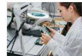
目視検査用照明機器の色温度、演色性評価
